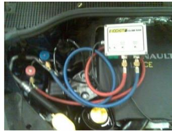
**Raccorder la sonde de température sur le CL 500:**
