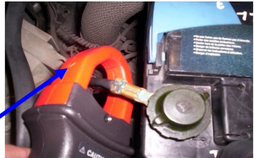
Une flèche est généralement repérée sur la pince pour déterminer le sens du courant.
