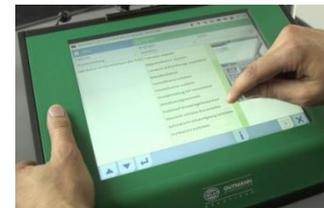
3. **Débrancher la sonde de température du moteur.** Effectuer une lecture des codes défauts avec l'outil d'aide au diagnostic et une lecture des paramètres.
