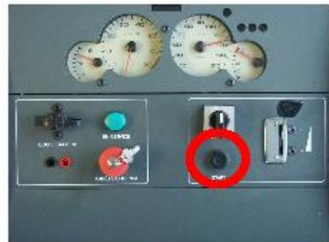
La commande d'accélérateur permet de régler le régime moteur.
