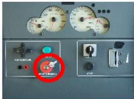
Mettre le contact en positionnant l'interrupteur en position "1" (+APC). Vérifier le niveau de la jauge à essence. Si nécessaire remplir le réservoir avant de démarrer le moteur.
